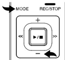
είδους λειτουργίας (TIME-Mode). Αριθμός μηνυμάτων, ποιότητα, διάρκεια του μηνύματος κλπ. εμφανίζονται στην οθόνη. Κρατήστε το πλήκτρο είδους λειτουργίας MODE μία δεύτερη φορά πατημένη, για να εμφανίσετε τις ρυθμίσεις ημερομηνίας και ώρας. Πατήστε το πλήκτρο ΚΑΤΩ πέντε φορές, μέχρι να εμφανιστεί το έτος (έχει προρυθμιστεί το 08).
